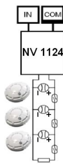
шлейф пожарных двухпроводных извещателей
